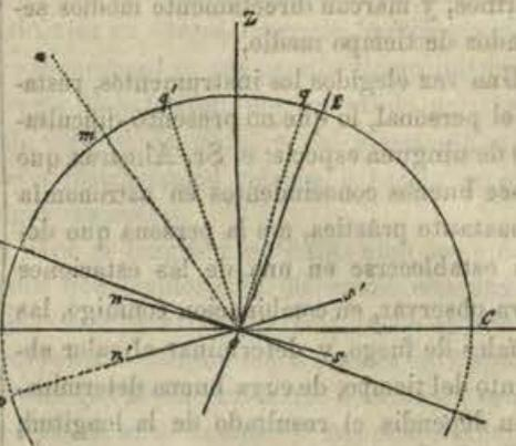
Si invertimos ahora el instrumento de 180° y dirigimos el anteojo á la misma estrella, el nivel tomará la posicion *n' s'* y el eje vertical aparente del instrumento vendrá á ser *O q'*; la graduacion que en esta posicion nos dará la altura de la estrella *p m* que llamaremos *h*, deberá ser disminuida del pequeño ángulo *A O n*, para tener la
